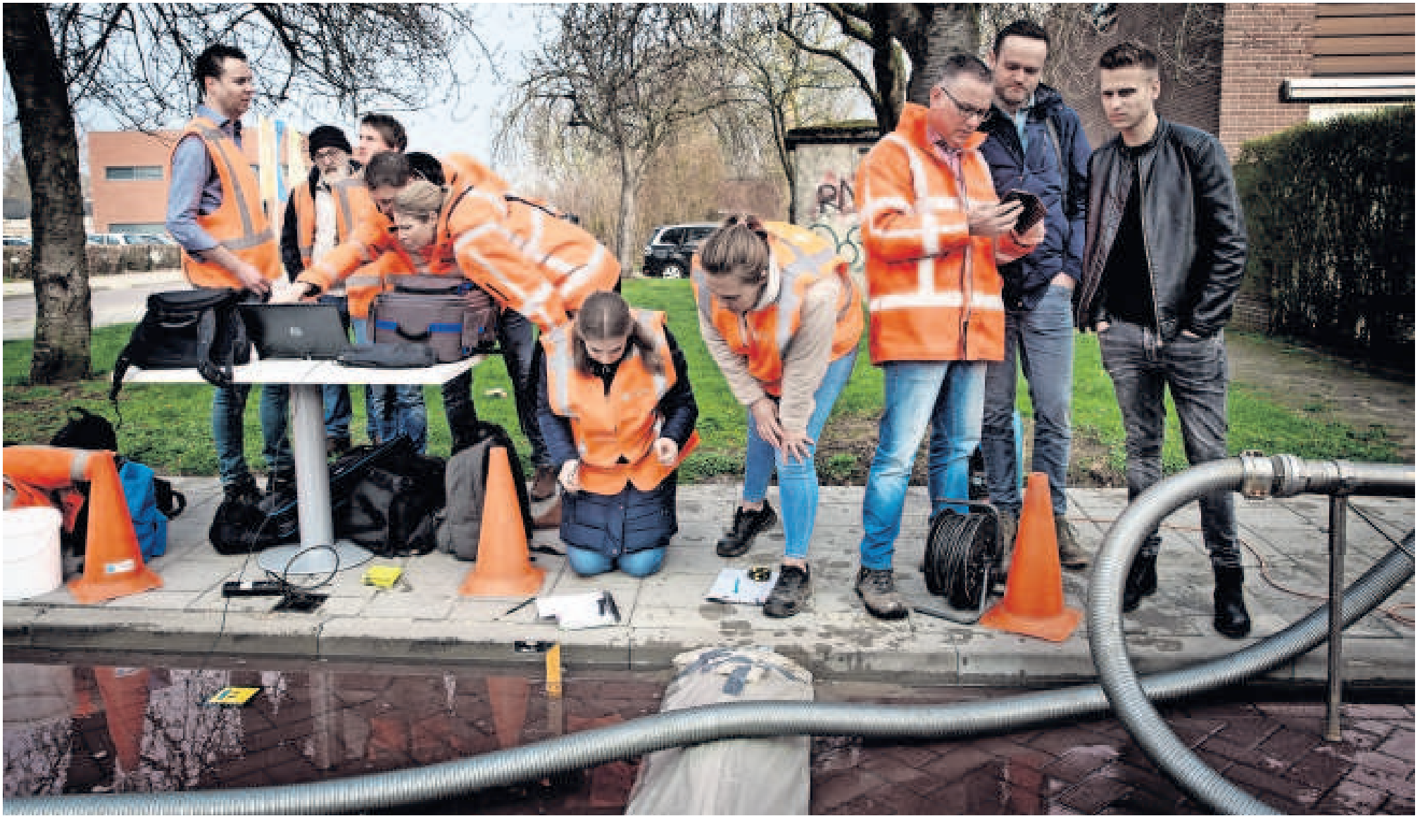
Studenten van Saxion Hogeschool en medewerkers van ingenieursbedrijf Tauw doen onderzoek naar het waterbergende vermogen van het wegdek. FOTO'S HERMAN ENGBERS
